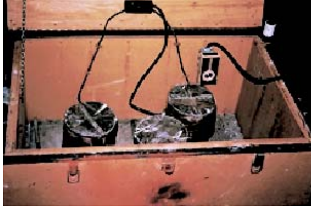
Resim – 3 : Beton numunelerin yalıtımlı kutuda korunması
